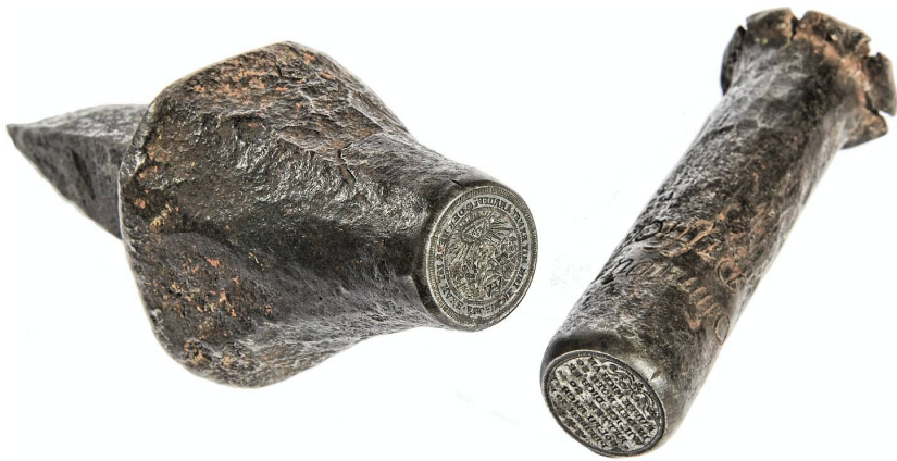
Abb. 8: Unter- und Obereisen für Hammerprägung. Prägestempelpaar einer religiösen Medaille, 17. Jhd. MHG Alter Bestand.
